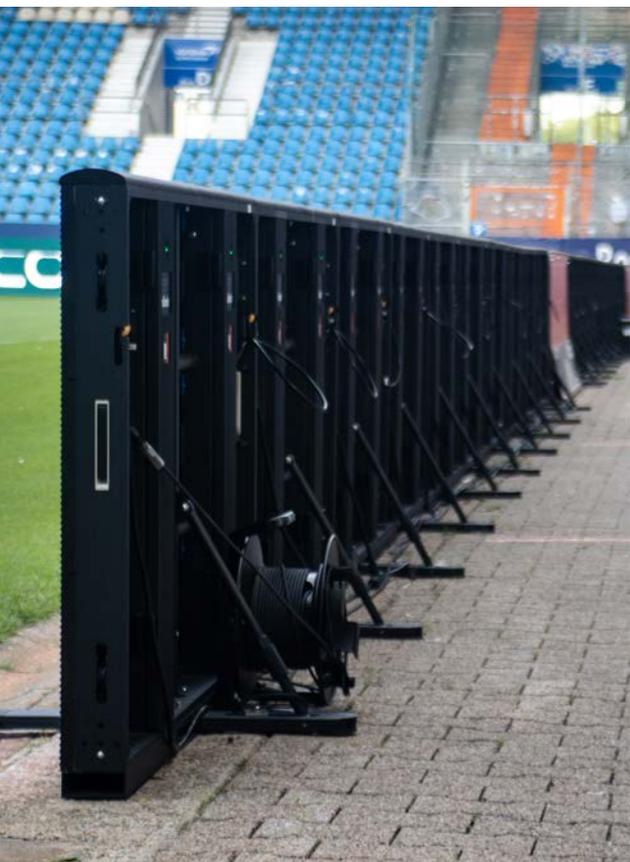
Bestandteil des Projekts war die Demontage der alten Anzeigetafeln, bevor die neuen Upix III Module montiert und in Betrieb genommen werden konnten. Mit nun 6.67 mm anstelle von 20 mm Pixelabstand, bieten die auf je 8 x 4,5 m gewachsenen Scoreboards die über 11-fache Anzahl an Pixeln bei einer Steigerung der Gesamtfläche von 17%. Das alte 4:3 Format mit 320 x 224 Pixel wurde dabei durch ein modernes 16:9 Format mit je 1200 x 675 Pixel ersetzt.
