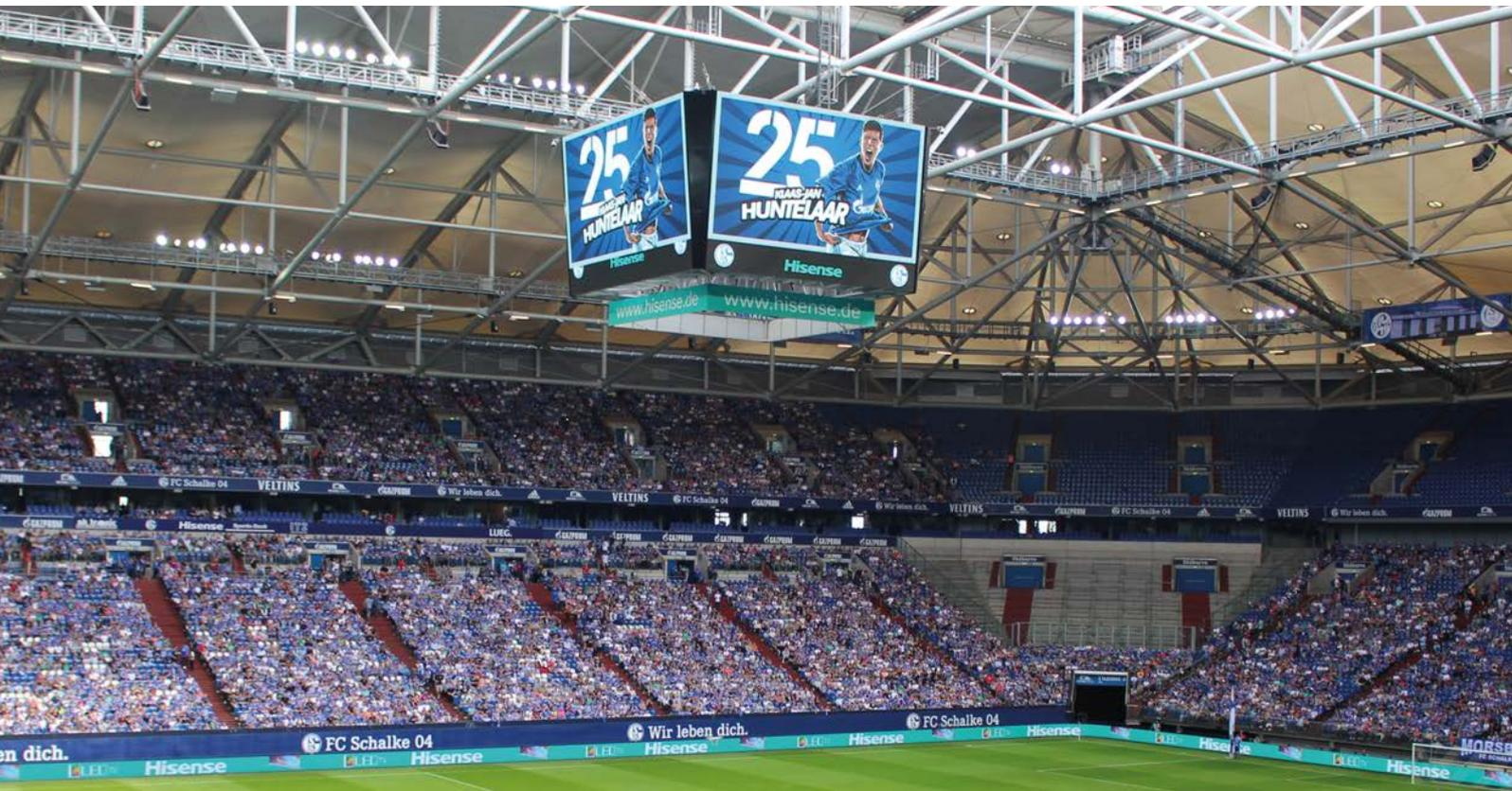
10.60 x 7.20 m pro Seite, 30 Tonnen schwer und mit LEDCON LED-Modulen ausgestattet – das ist der Video-Würfel, welcher seit 2016 in der VELTINS-Arena offiziell in Betrieb ist. Die Gesamtfläche von 305,28m<sup>2</sup> - je Seite 76,32 m<sup>2</sup> - besteht aus Upix 10 Modulen mit einem Pixelpitch von 10 mm und einer Auflösung von 1060 x 720 Pixeln.
